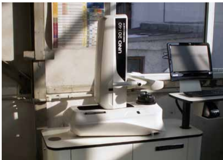
K novinkám dílenské výbavy patří i kontrolní přístroj pro nástroje na vrtání, frézování a soustružení UNO 20/40 od DMG MORI
